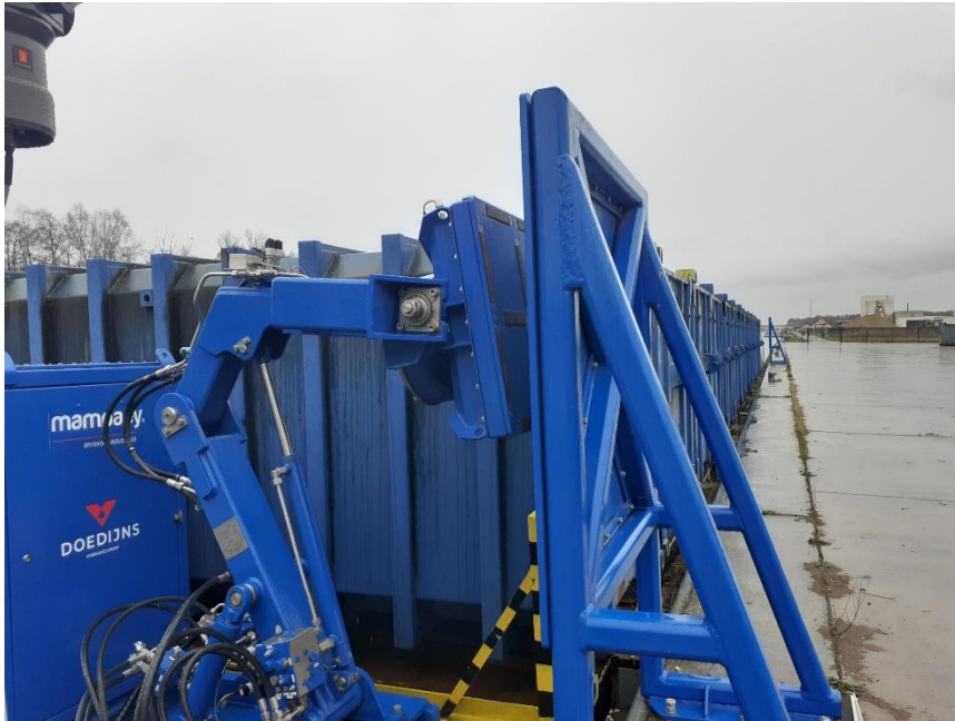
Figuur 5. Het magnetisch afmeersysteem op de Zulu 4 in werking op de kade in Mol.
