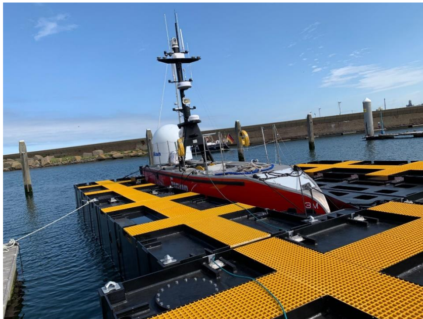
Figuur 21: Fugro test hoe USV's autonoom kunnen docken (2022, IJmuiden)
