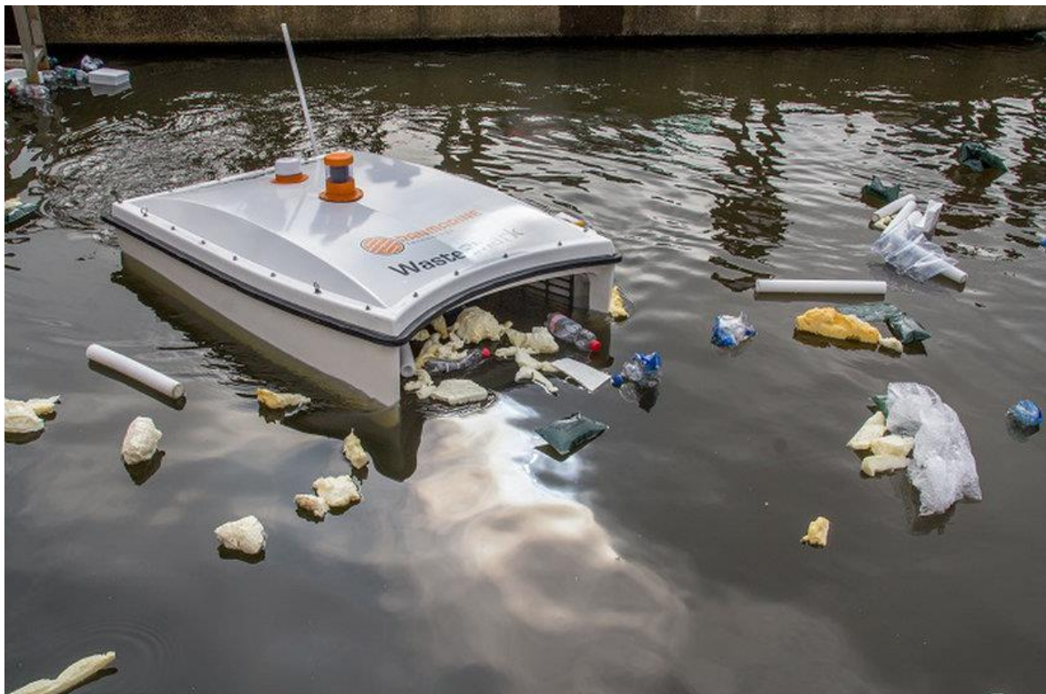
Figuur 4: De Wasteshark van RAN Marine is een varende drone die rommel op het water kan verzamelen.
