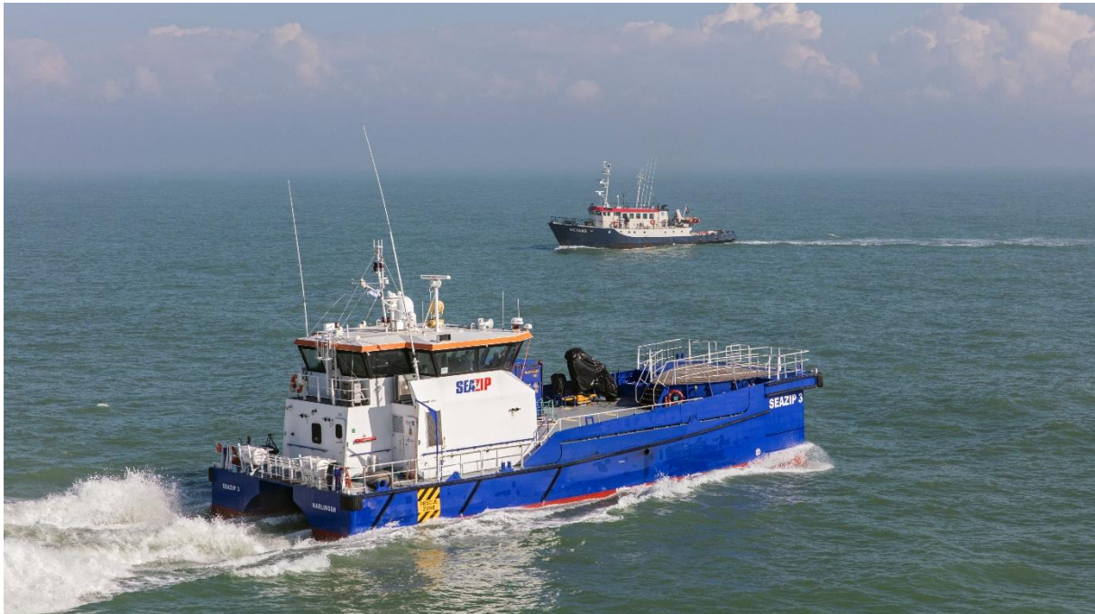
Figuur 6: De Seazip 3 en de Willem Barentz tijdens proeven met autonoom varen voor de kust bij Den Helder in het voorjaar van 2019. De proef was onderdeel van het Joint Industry Project Autonoom Varen.
