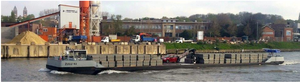
Figuur 5: De Zulu 2 van Blue Line Logistics uit Vlaanderen is een voorbeeld van zo'n nieuw concept. Het schip kan door één bemanningslid worden bevaren, dat bemanningslid slaapt gewoon thuis. Voor het laden en lossen is nauwelijks infrastructuur aan de wal kant nodig.
