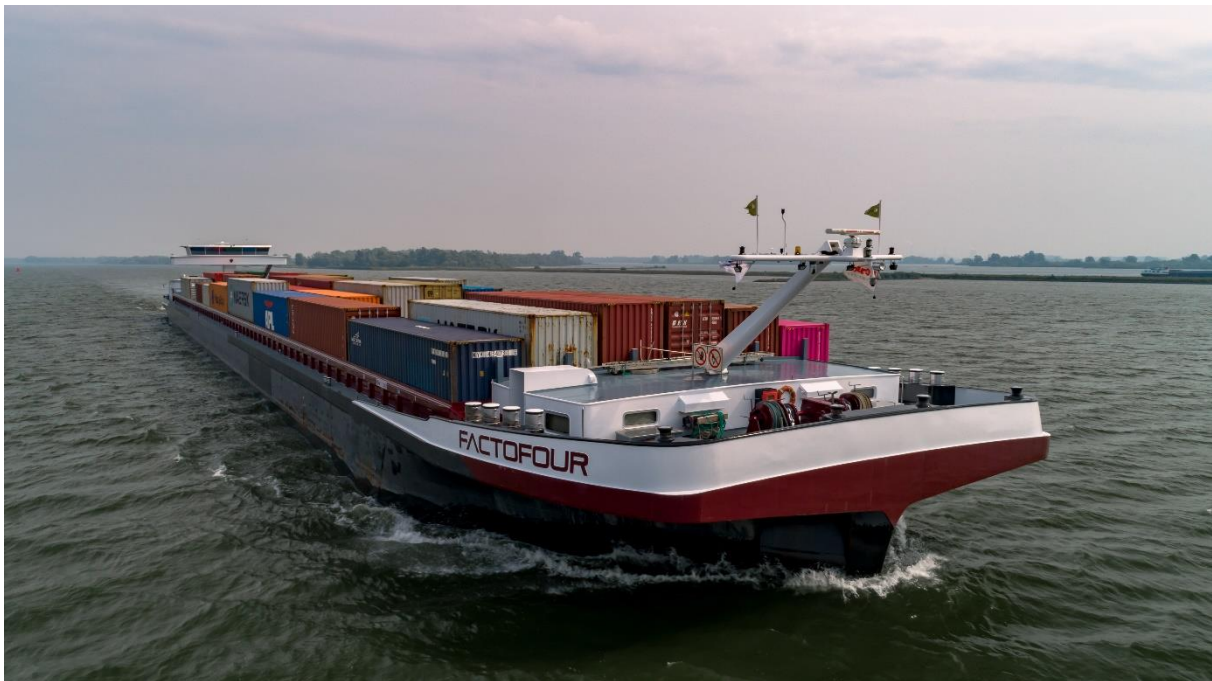
Figuur 10: De Factofour van Delfia Inland Shipping wordt door het bedrijf Shipping Technology ingezet om nieuwe applicaties op weg naar verregaande geautomatiseerd varen te testen.
